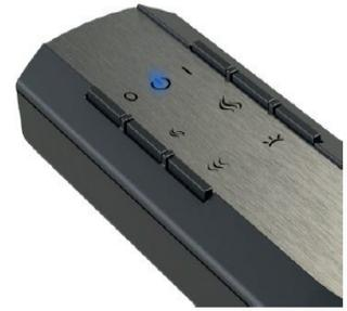
Alle Ausführungen der Fernbedienung werden mit Batterien betrieben. Bei allen Typen verringert sich die Sendeleistung, wenn die Batterien fast leer sind. Daher sollten die Batterien jährlich ersetzt werden, um Probleme zu vermeiden.
